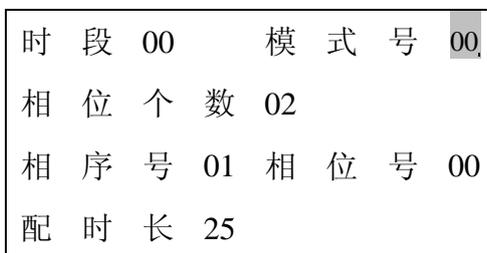
5. 按“右”键光标移动到配时长位置，使用“+”、“-”设置第一相位（相序号 01）配时时间。（在光标所在的配时状态下按“步进”可进入到
