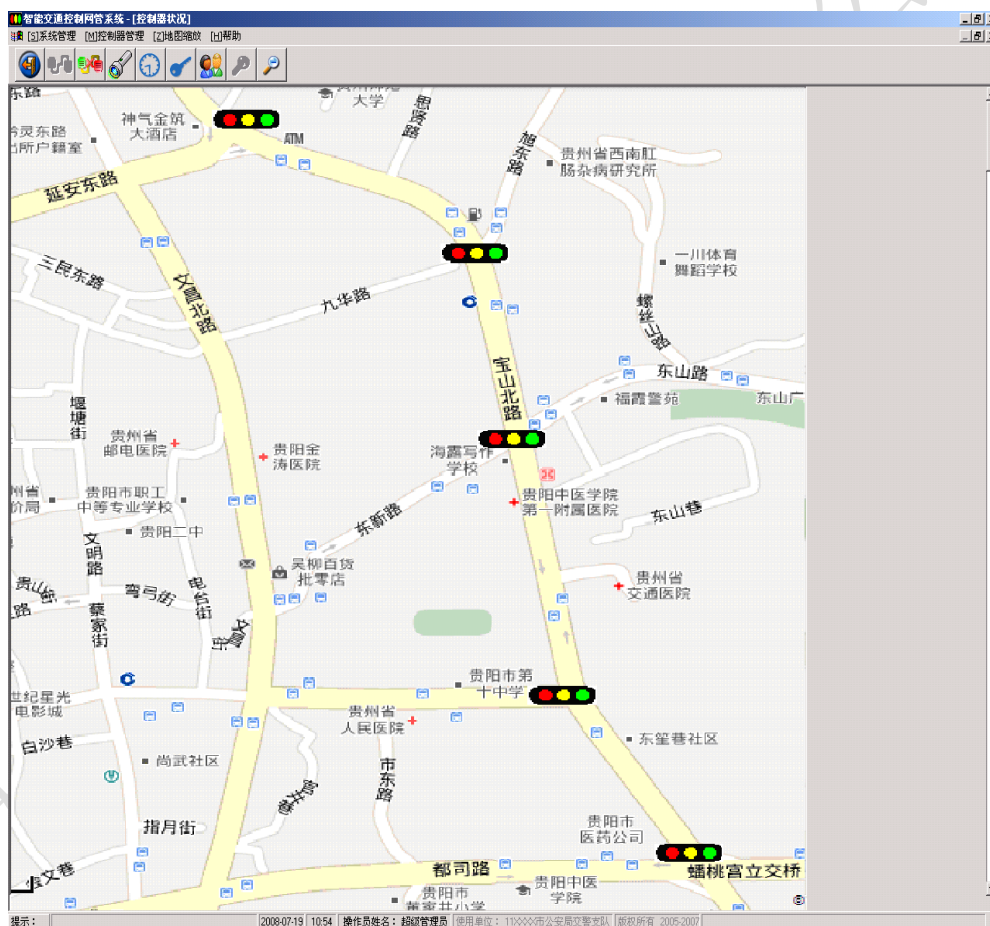
图 2-1 集成系统将信号系统中的设备位置及状态进行集成
